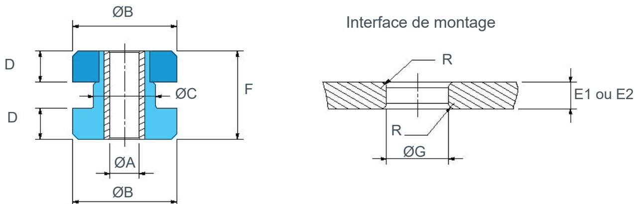
L'épaisseur du montage peut être  $E_1$  ou  $E_2$  en fonction de la charge et de la fréquence propre nécessaires (voir tableau des caractéristiques techniques).
