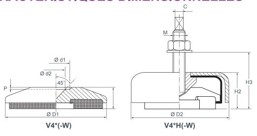
$<sup>^{*}</sup>$  Remplace un chiffre pouvant aller de 3 à 6 ; voir détails dans le tableau ci-dessous. W = Coussin métallique plus épais.
