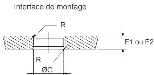
L'épaisseur du montage peut être  $E_1$  ou  $E_2$  en fonction de la charge et de la fréquence propre nécessaires (voir tableau des caractéristiques techniques).
