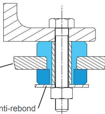
Les rondelles en acier galvanisées sont recommandées pour le montage des plots.
