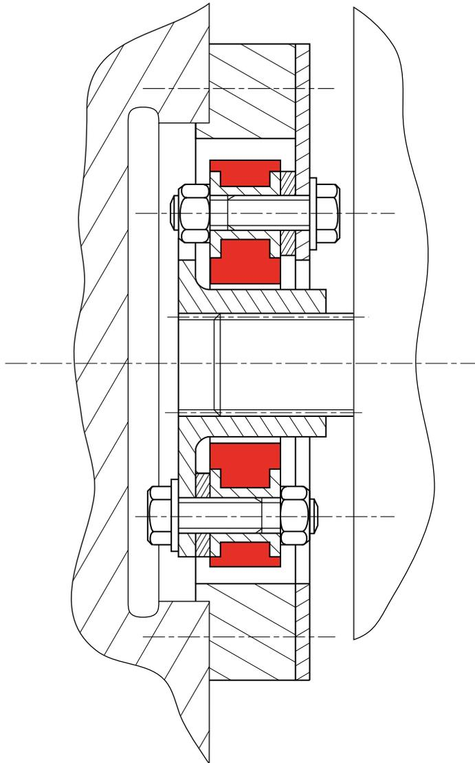
**Exemple** : liaison moteur électrique / pompe volumétrique : montage sur arbre cannelé et volant.
